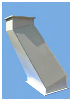
Рис. Утка прямоугольная с переходом (толщина стенки 2-5мм, соединение на фланцах толщ. 8 -15 мм)
