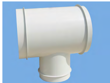
Рис. Тройник круглого воздуховода (толщина стенки 2-5мм, соединение муфтовое)
