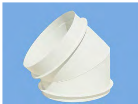
Рис. Отвод 45 градусов круглого воздуховода (толщина стенки 2-5мм, соединение ниппельное)
