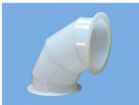
Рис. Отвод 90 градусов круглого воздуховода (толщина стенки 2-5мм, соединение на фланцах толщ. 8 -15 мм)
